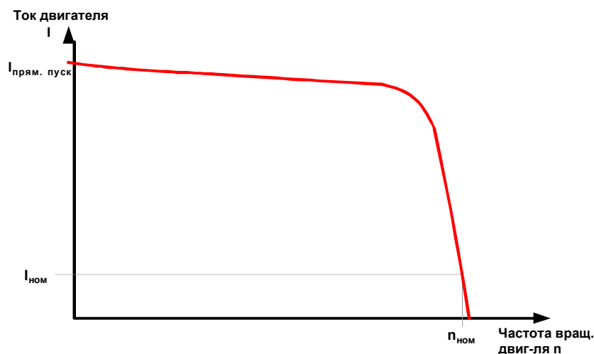
Рисунок 1-1: Типичные параметры пускового тока трёхфазного асинхронного двигателя
